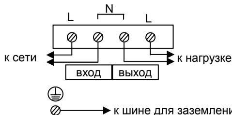
Рисунок 6.1 Схема подключения выходных цепей стабилизатора R 3000N (вид на заднюю панель стабилизатора).
