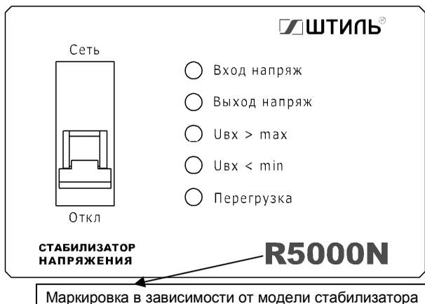
Рисунок 4.1 Передняя панель стабилизатора
